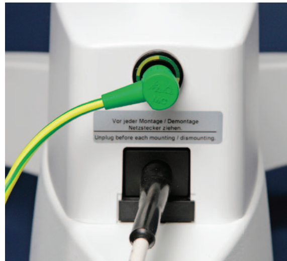
FIGURE 11: Equipotential bonding connector on mobile stand with equipotential bonding cable
