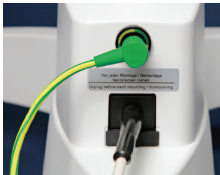
FIGURE 10: Equipotential bonding connector on mobile stand with equipotential bonding cable
